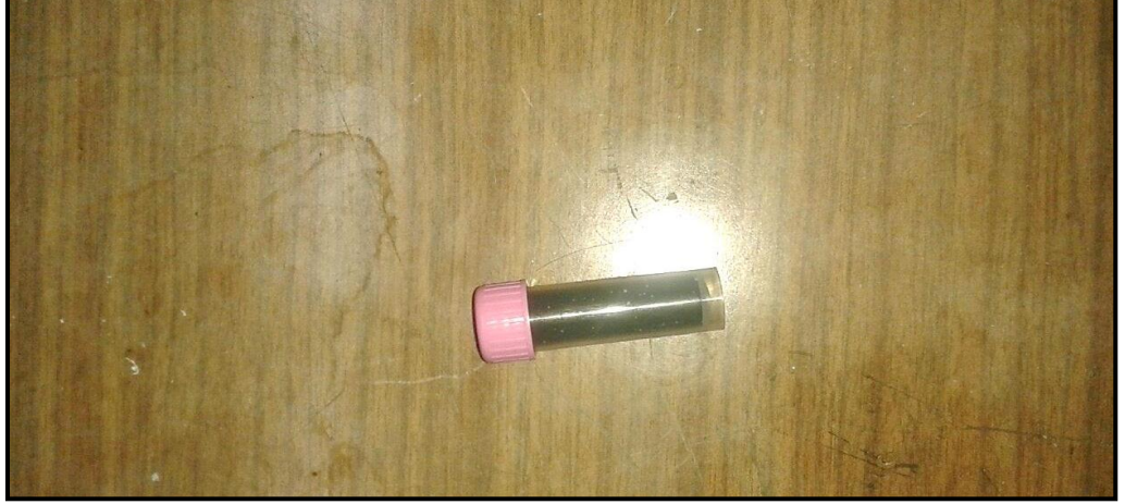
شكل ( ١ ) انبوبة بلاستيكية تحتوى على المركب المغناطيسى
